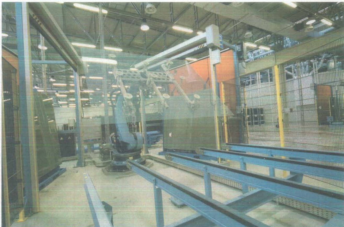
↳ Il robot che si occupa della movimentazione delle lastre di vetro necessarie alla produzione dei pannelli fotovoltaici.
